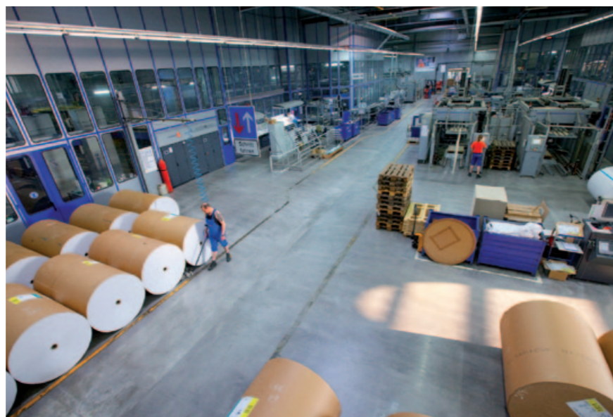
Im Rollenoffset-Druckverfahren werden bei Evers-Druck täglich bis zu 400 Tonnen Papier verarbeitet
